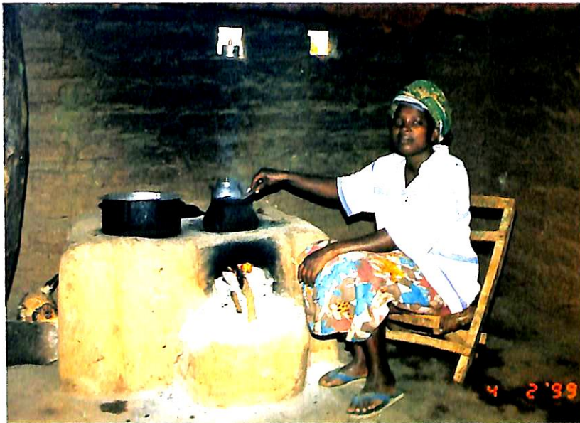
Jiko lenye mashimo mbili Matope kwenye pande ya mbele yalitolewa ili jiko lionekane nzuri. (Bi. Kasemba Mwambu, Chuluni Division, Tarafa ya Kitui)
