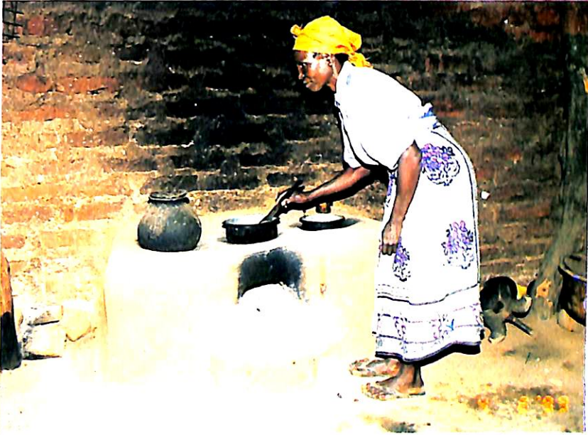
Aina kamili ya Enzaro jiko lenye mashimo matatu. Shimo moja limewekwa nyungu ambayo haitolewi ili kuwezesha kupata maji yaliochemka wakati wowote. (Bi. Peles Kabibu, Chuluni District)
